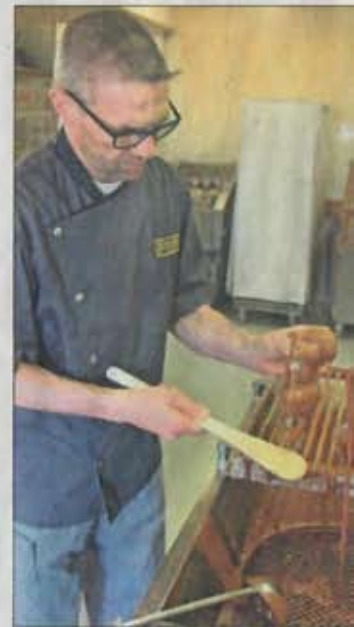
Das Giessen ist eine heikle Angelegenheit. Bereits bei einer Abweichung von einem halben Grad Celsius kann es vorkommen, dass die fertigen Osterhasen nicht mehr schön glänzen.
